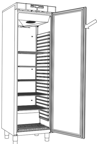
Le joint de porte doit être nettoyé régulièrement avec une solution savonneuse douce.
