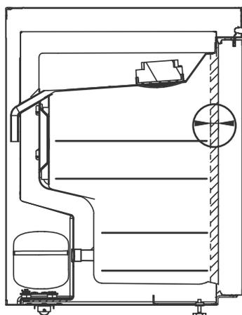
Il doit y avoir un espace de 20 mm entre la partie intérieure de la porte et les éléments stockés pour permettre la circulation de l'air à l'avant de l'armoire.
