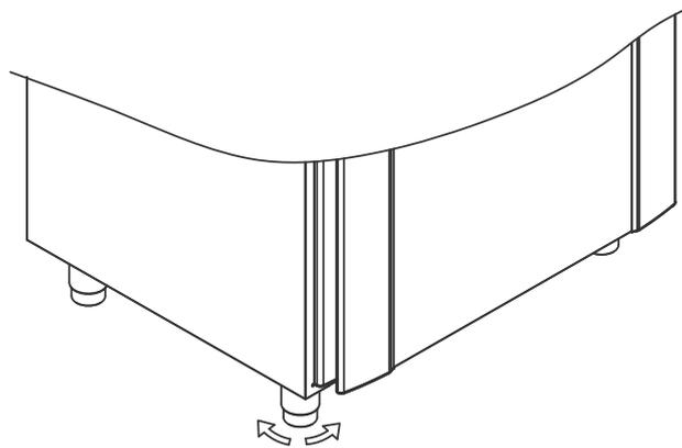
**I-10-11\*:** Für Geräte mit Rollen ist ein ebener Boden erforderlich, um eine stabile Aufstellung und eine sichere Benutzung zu gewährleisten. Nach Aufstellung des Geräts sind die beiden vorderen Rollen zu arretieren.
