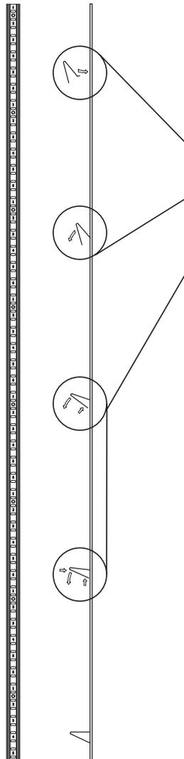
**I-16\*** : Montez les clips de support d'étagère sur les rails muraux en utilisant la numérotation sur les rails muraux pour déterminer la bonne hauteur d'étagère. Enfin, placez l'étagère sur les supports. Notez que le rebord saillant de l'étagère doit être orienté vers l'extérieur, comme indiqué sur l'illustration.
