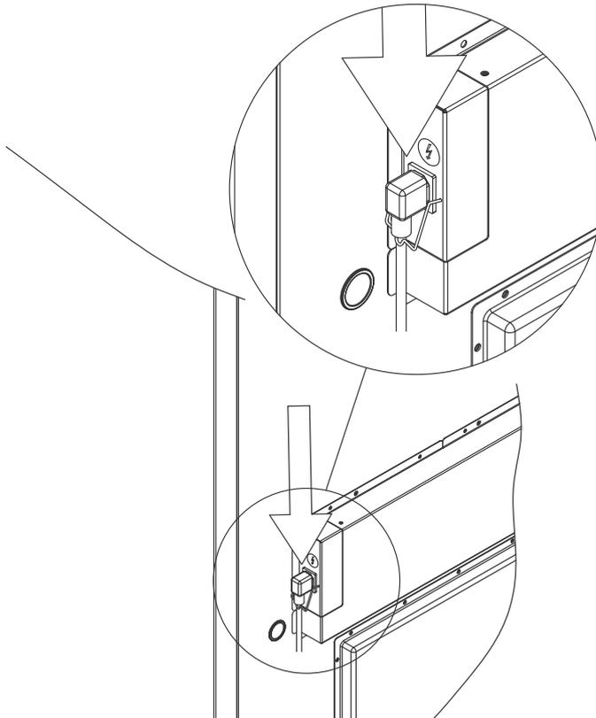
L'appareil doit être raccordé à l'alimentation externe à l'aide d'un dispositif approprié qui empêche mécaniquement la fiche et la prise d'être séparées par inadvertance.
