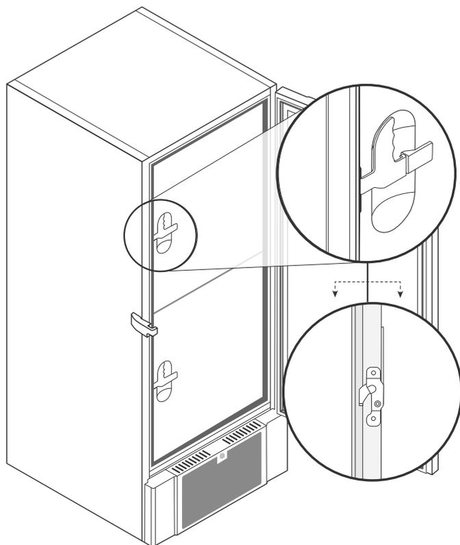
**I-18\*:** Les portes intérieures sont verrouillées lorsque le levier de porte s'enclenche et s'appuie sur la porte intérieure.
