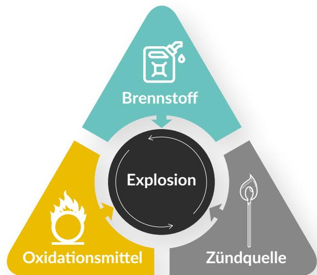
Kühl- und Tiefkühlschränken könnte dies ein Funke oder Wärme mit ausreichender Energie zur Auslösung einer chemischen Reaktion zwischen dem Brennstoff und dem Oxidationsmittel sein. Funken können durch statische Aufladung oder im elektrischen System des Kühl- oder Tiefkühlschranks entstehen.
