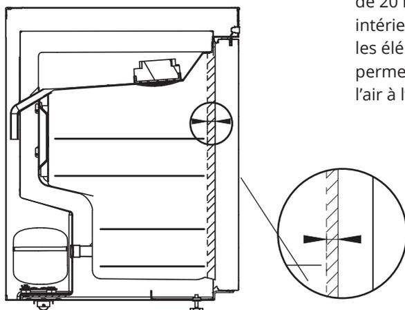
Il doit y avoir un espace de 20 mm entre la partie intérieure de la porte et les éléments stockés pour permettre la circulation de l'air à l'avant de l'armoire.
