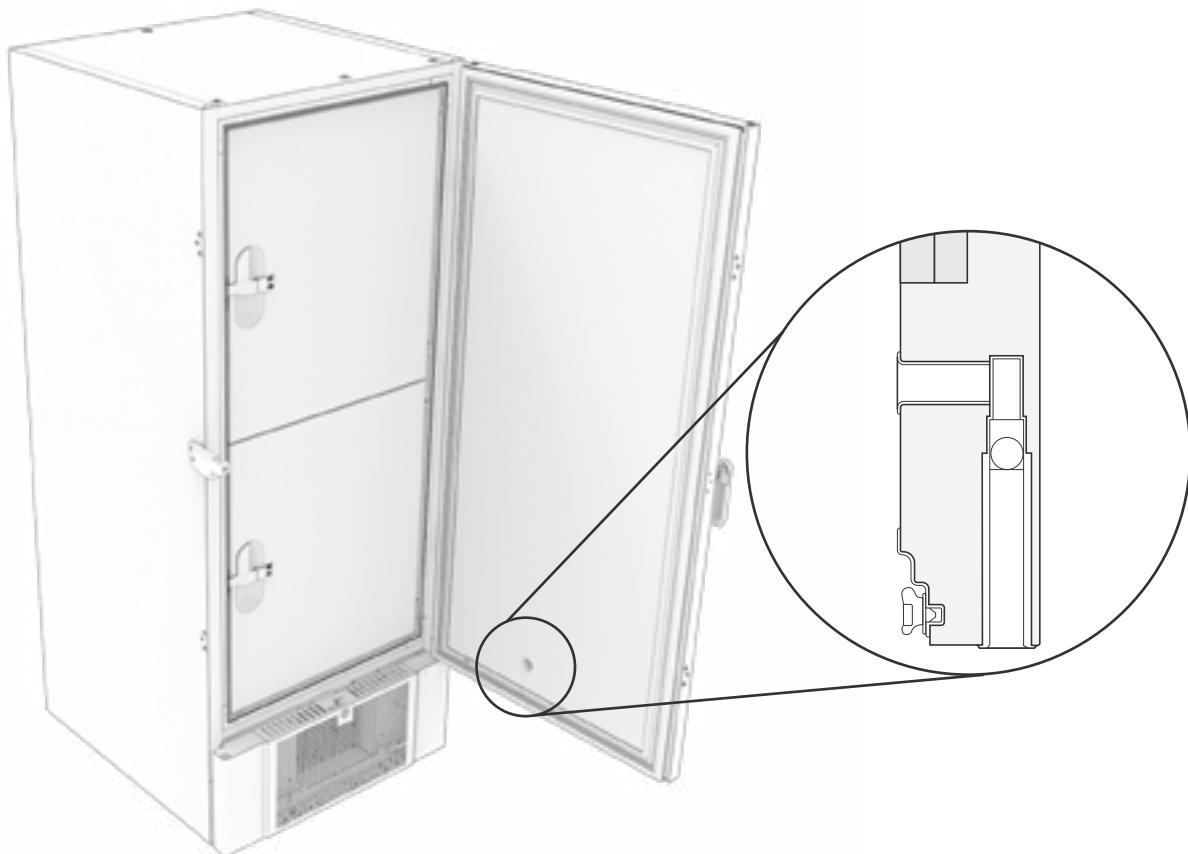
La ilustración anterior muestra la ubicación de la válvula de compensación.
