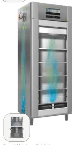
Durch ein Rückschlagventil wird beim Öffnen der Klappe Umgebungsluft in den Schrankinnenraum gesaugt, wodurch der Druck im Innenraum ausgeglichen und potenziell kontaminierte Luft ausgespült wird.
