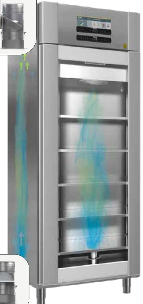
Durch ein Rückschlagventil wird beim Öffnen der Klappe Umgebungsluft in den Schrankinnenraum gesaugt, wodurch der Druck im Innenraum ausgeglichen und potenziell kontaminierte Luft ausgespült wird.
