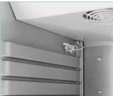
Zusätzlicher Fühler (E-Fühler) zur Einbringung in ein Medium als Standard bei allen BioCompact II Schränken.
